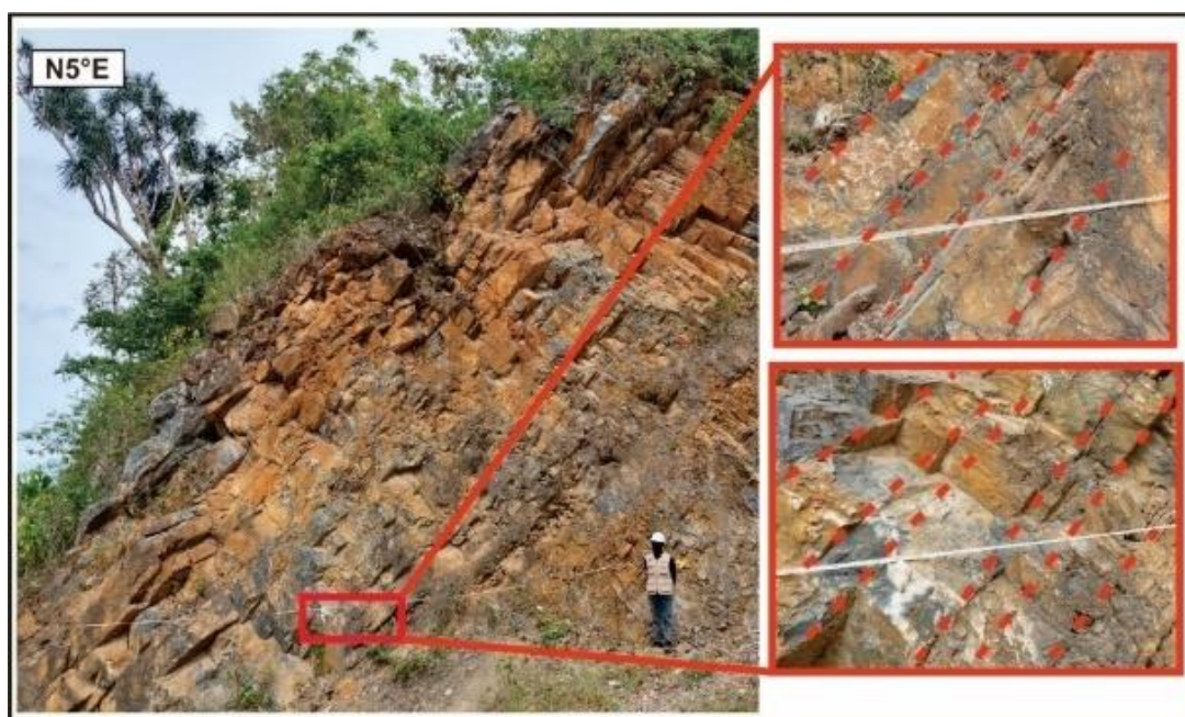
Gambar 4. Kehadiran bidang perlapisan yang nampak searah dengan muka Lereng-3. Jurus perlapisan berarah timur – barat
