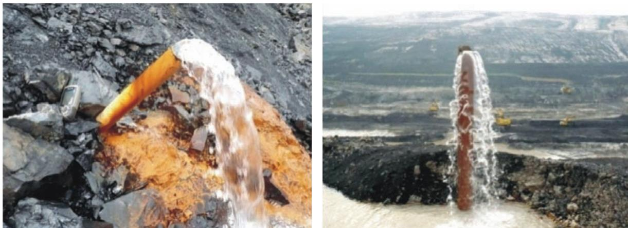
Gambar 2. *Vertical dan inclined dewatering hole* untuk mengurangi kandungan air tanah
