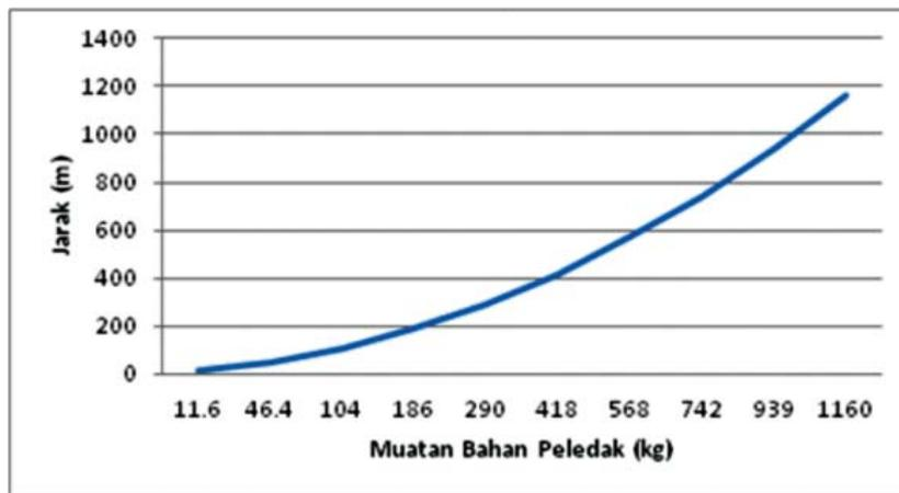
Gambar 7. Jumlah bahan peledak per waktu tunda vs. jarak (PPV = 5 mm/s)
