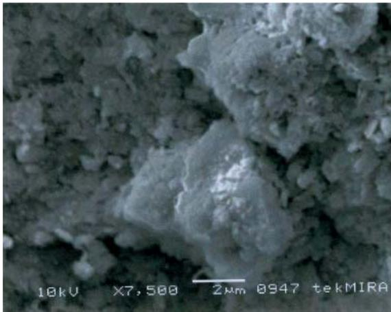
Gambar 6. Tekstur granular dan porus pada ampas pencucian bauksit (AP)
