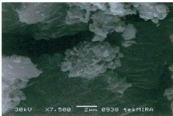
Gambar 4. Foto mikro residu bauksit (RB), menunjukkan tekstur pelat (hematit) dan granular (gibsit)
