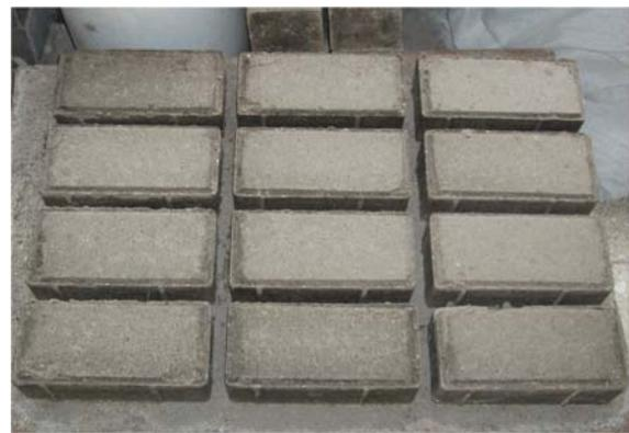
Gambar 3. Hasil pencetakan cara mesin hidrolik
